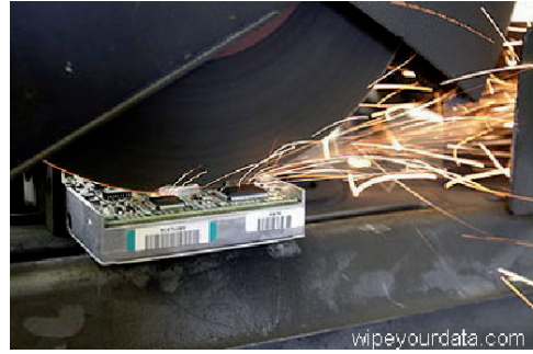
Przykład dysków przecinanych na fragmenty za pomocą szlifierki
